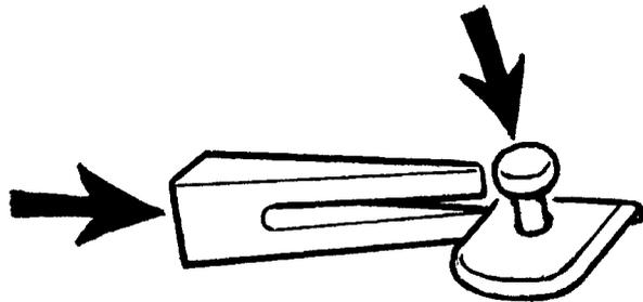
2. Stecken Sie die Holzstifte in die Bohrungen der Laschen (abgeflachte Seite des Kopfs zum Rahmen) und fixieren Sie die Verbindung mit den Spannkeilen durch leichtes Einschlagen.
